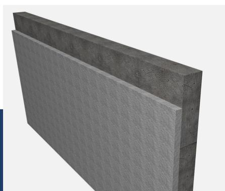
Интеграция камня ТИК в стену позволяет увеличить плотность пенобетона до 800-1000 и получить очень тёплые и прочные стены.
