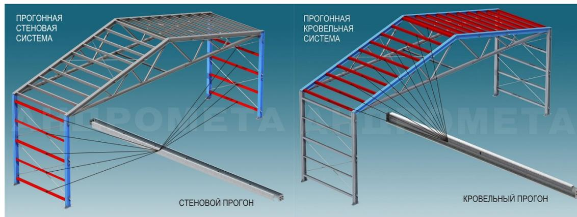
**Выполнение отверстий 3 основных типоразмеров: Ø14 (M12), Ø18 (M16), Ø22 (M20) в любом месте на стенках или полках прогонов. Другие диаметры - по заданию. Позиционирование и число отверстий: любое, согласно заказу.**
