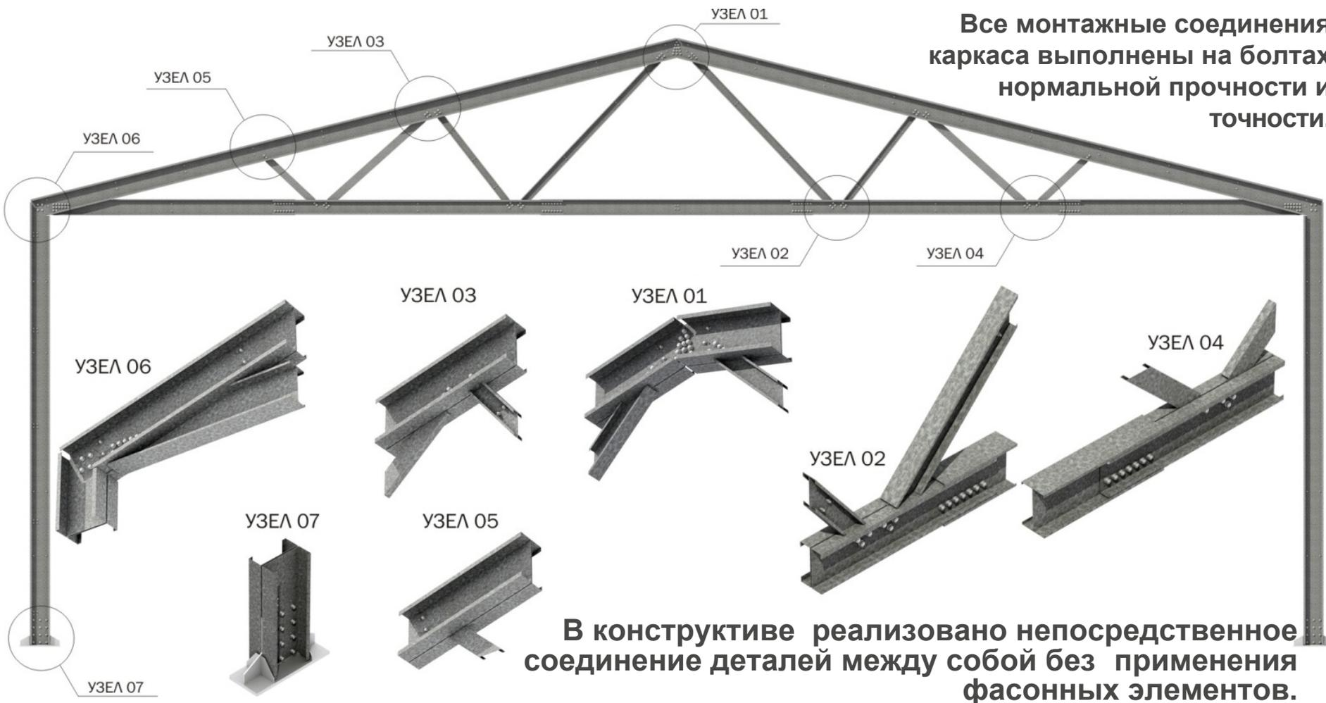
В конструктиве реализовано непосредственное соединение деталей между собой без применения фасонных элементов.
