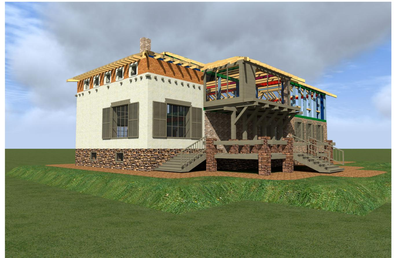
На изображении виден комбинированный способ строительства. Самое разумное применение материалов таково: Первый этаж монолитное литьё пенобетон марки 600; Часть дома со вторым светом марка пенобетона 800-1000 плюс ТИК; каркасная часть утепляется камнем ТИК толщиной 200 мм.
